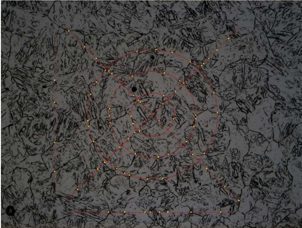
Figura 20: Método dos interceptos utilizado para medir o tamanho de grão do aço 9%Ni.
