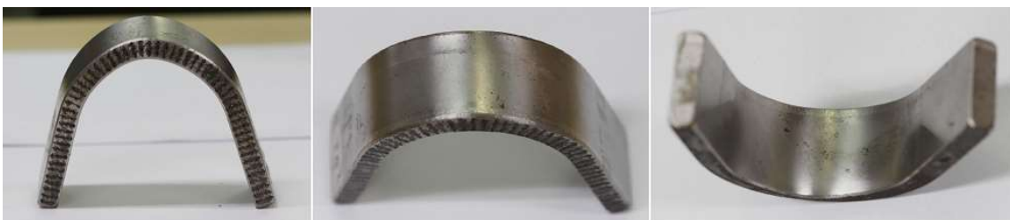
Figura 21: diferentes ângulos dos corpos de prova ensaiados no dobramento.
