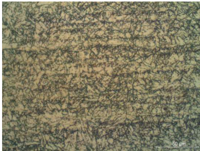
Figura 8: micrografia do aço 9%Ni como recebido. (Adaptado de [19])
