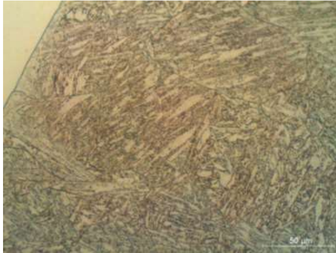
Figura 10: Região de grãos grosseiros da zona termicamente afetada do aço 9%Ni. [19]
