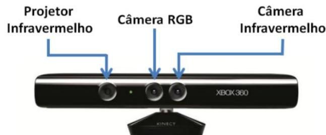
Figura 2.4: Detalhamento dos sensores do *Kinect*.
