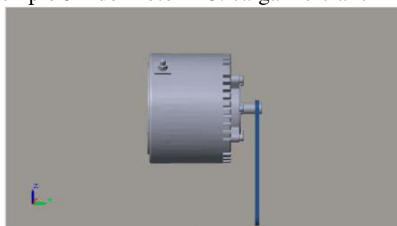
Figura 5.1: Exemplo 3D do Motor DC: carga inercial em formato de barra
