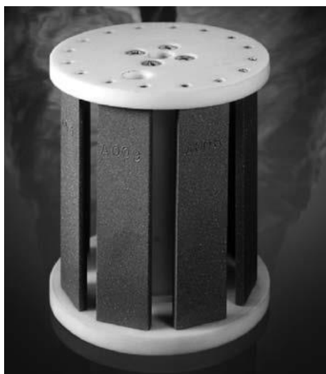
Figura 3 – Gaiola do Rotating Cage. (Imagem de ASTM G184) [17]
