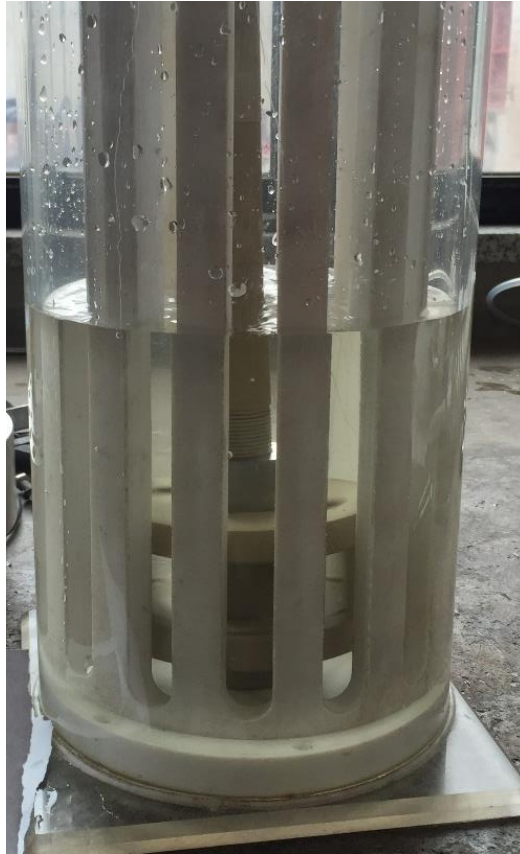
Figura 13– Rotating Cage com 540 RPM de rotação com a presença de quebra-vórtice.
