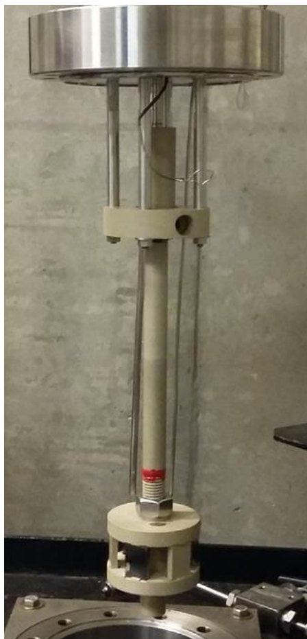
Figura 10 – Montagem do sistema Rotating Cage Eletroquímico.
