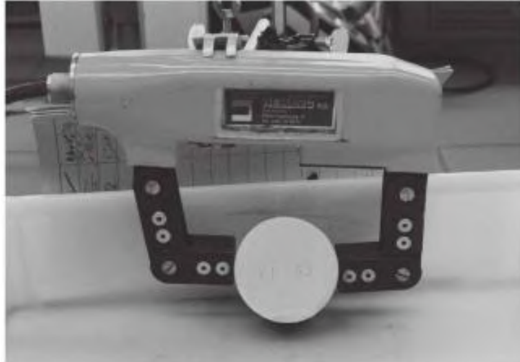
Figura 17: Recuperação da numeração 'XF 63' em um aço ferrítico por partículas magnéticas. [7]
