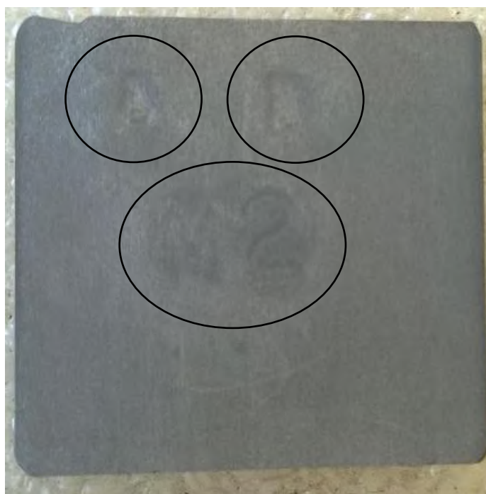
Figura 53: Revelação dos caracteres 'A', 'B', 'M' e '2' na amostra 1c de alumínio.
