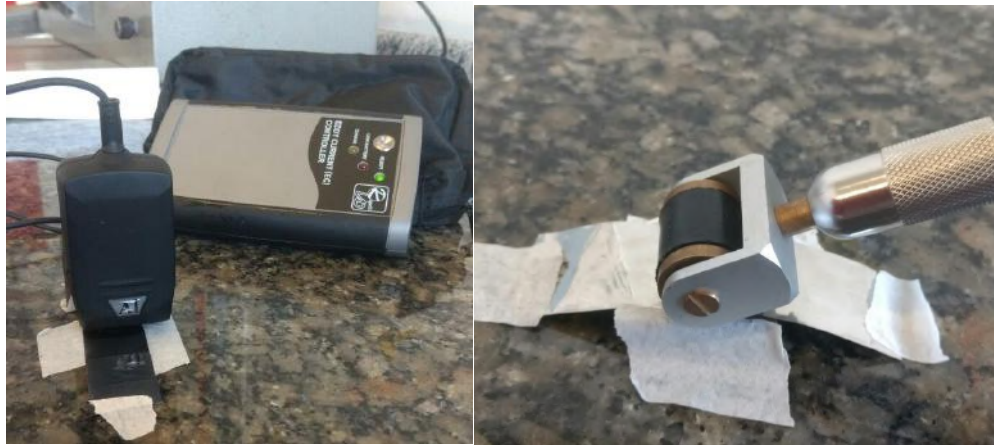
Figura 45: Passagem do “AI-scanner” sobre a fita (à esquerda) e passagem de um ímã sobre a fita (à direita).
