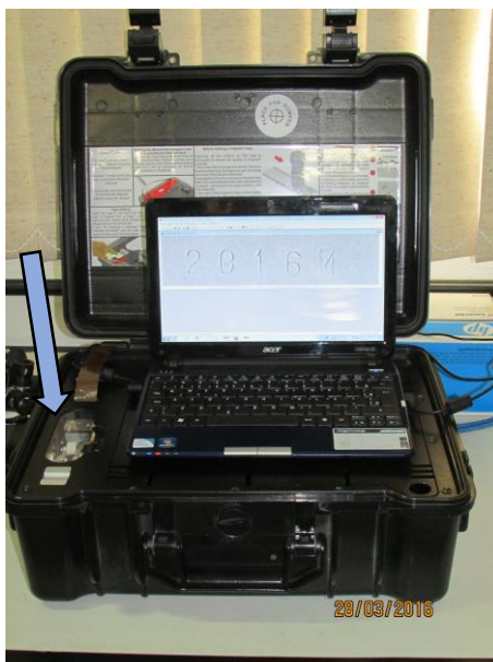
Figura 42: Equipamento Regula Modelo 7515. Estação de trabalho com o leitor magneto-óptico (indicado pela seta azul) e o notebook contendo o software que fornece a imagem obtida com a leitura da fita. [8]
