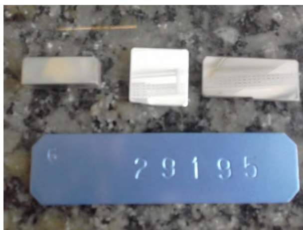
Figura 81: Comparação entre os tamanhos das amostras menores com uma das chapas fornecidas pela Regula. As dimensões das amostras da Regula são (11,5 x 3 x 0,15 cm)
