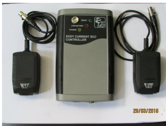
Figura 44: Controlador de correntes parasitas (centro) e os indutores para materiais paramagnéticos (à esquerda “Al-scanner”) e materiais ferromagnéticos (à direita “Fe-scanner”). [8]
