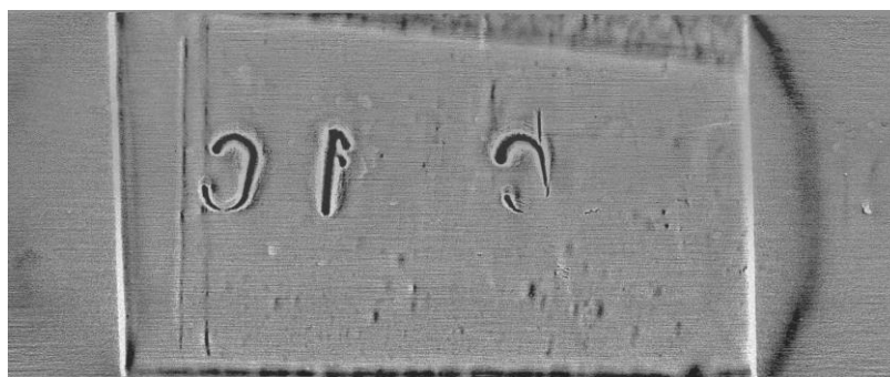
Figura 60: Imagem por magnetografia da superfície da amostra de aço estampada com os caracteres '1' e 'C'.
