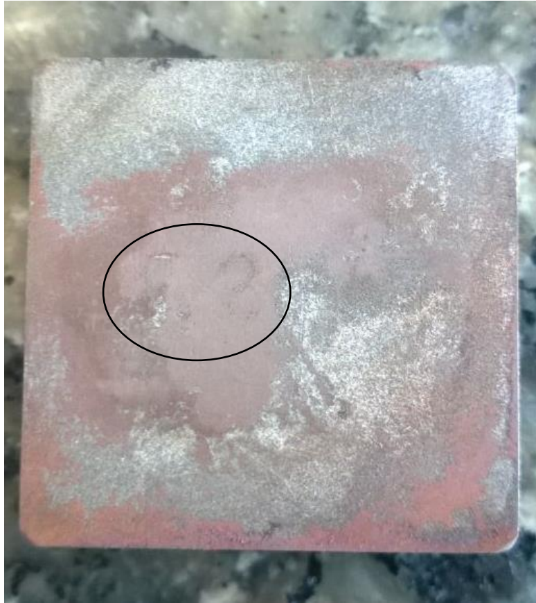
Figura 54: Revelação dos caracteres 'F' e '2' na Amostra 3c de aço.
