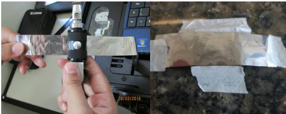
Figura 43: Desmagnetização de uma fita prateada (à esquerda) e fita posicionada sobre a amostra (à direita). [8]
