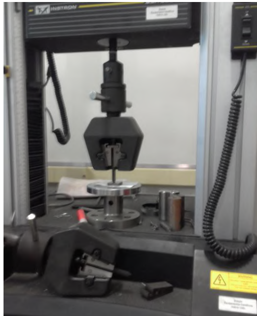
Figura 35: Equipamento para realização de ensaios de tração Instron utilizado para estampar as amostras. Foi utilizada uma carga de 500 Kg a uma velocidade de 1000 mm/min.
