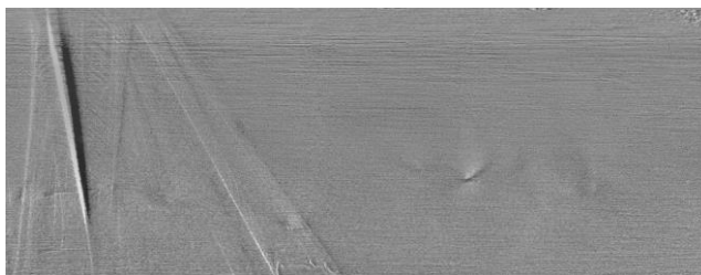
Figura 58: Imagem por magnetografia da superfície da amostra 3d de aço comum.
