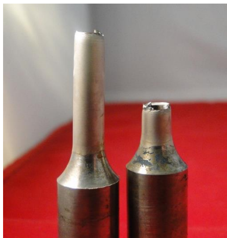
Figura 53 – Aparência do CP1 após ensaio.
