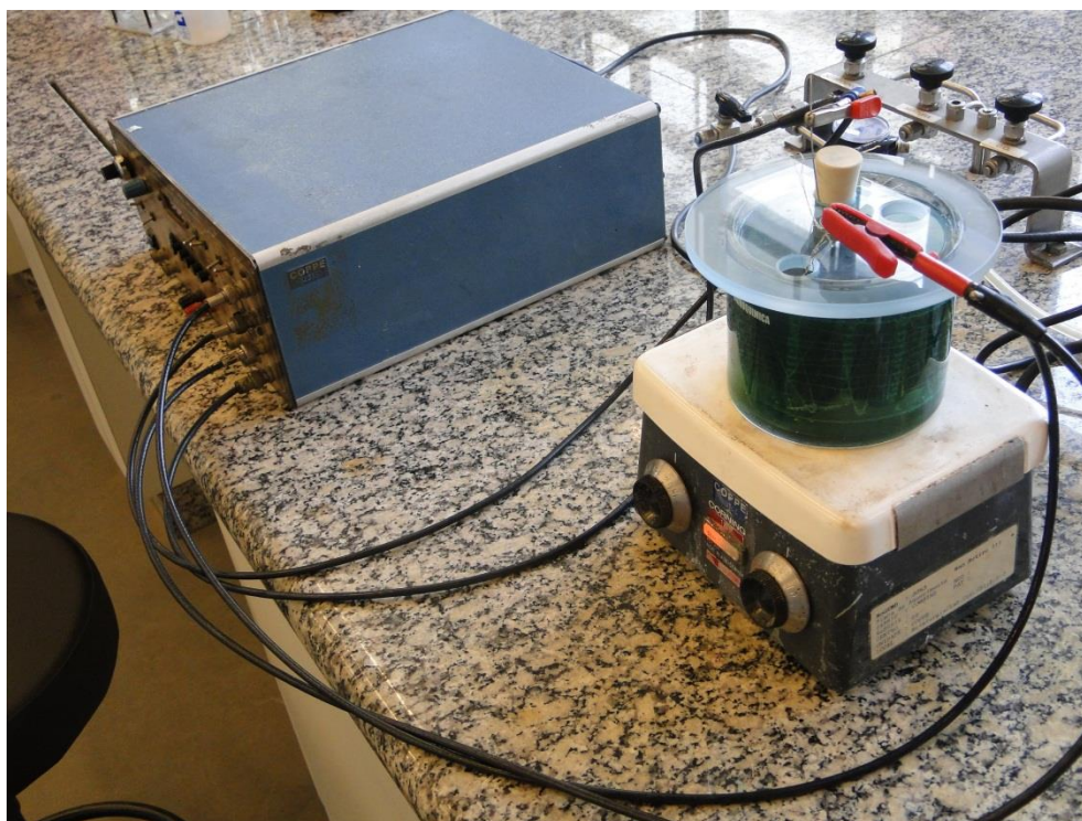
Figura 15 - Sistema para eletrodeposição de níquel. Podem ser observados o potenciostato e agitador magnético.
