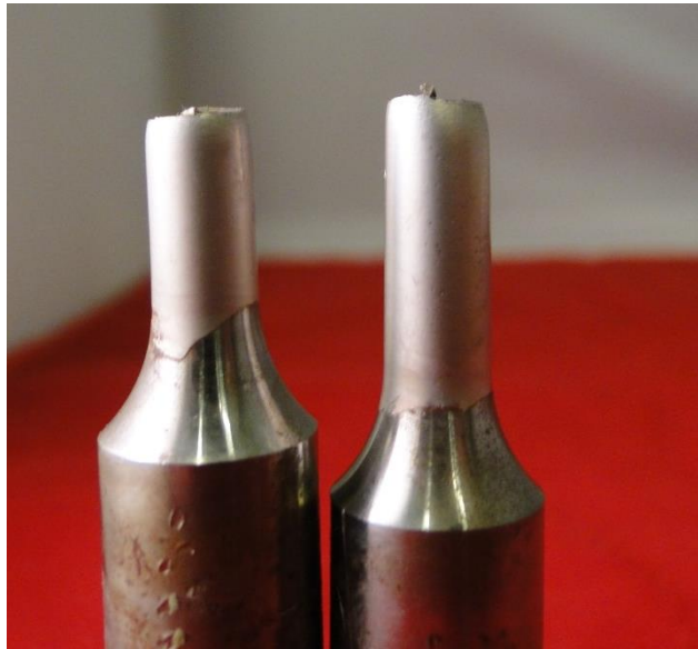
Figura 55 - Aparência do CP4 após ensaio.
