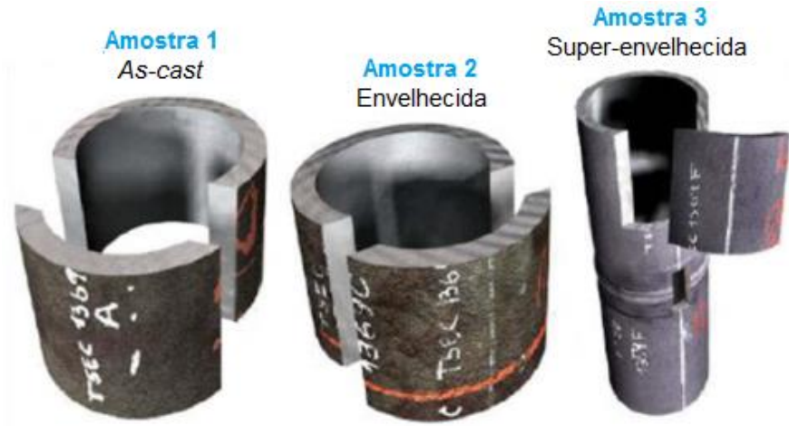
Figura 3.3 - Tubos dos quais foram obtidos os cortes estudados. Adaptado de CORREA (2013)
