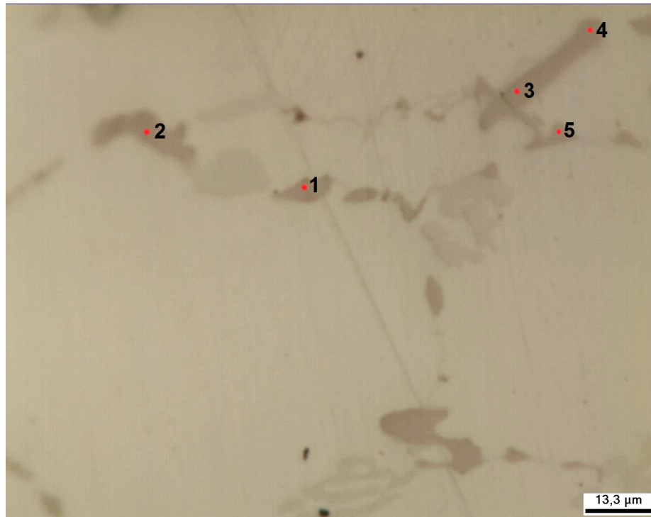
Figura 4.13 - Imagem do “bulk” da Amostra 1, obtida com a objetiva de 100x, destacando os carbeto de nióbio que foram analisados pela técnica Raman
