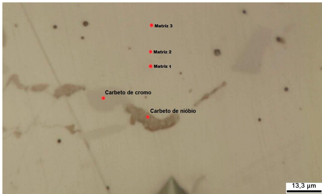
Figura 4.11 - Imagem obtida por microscópio usando a objetiva de 100x da região destacada na figura anterior. Nos pontos destacados foram realizados ensaios Raman
