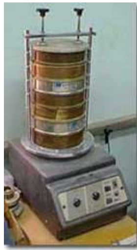
Figura 3.5: Conjunto de Peneiras com base vibratória
