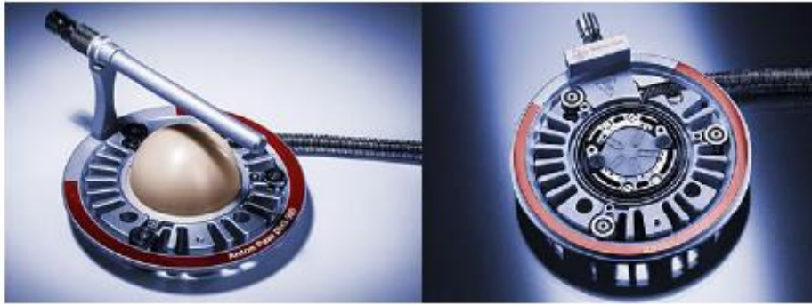
Figura 12 - Forno acoplado ao difratômetro de raios X
