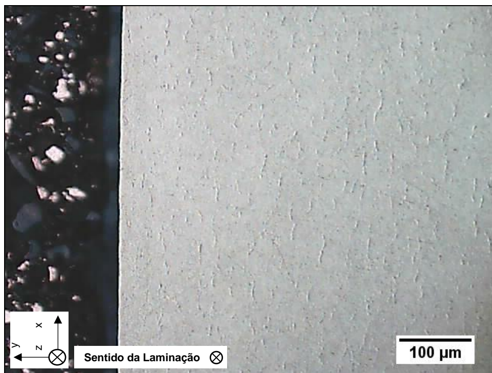
Figura 37. Micrografia da liga Zr-Nb (aumento de 100x nominal).
