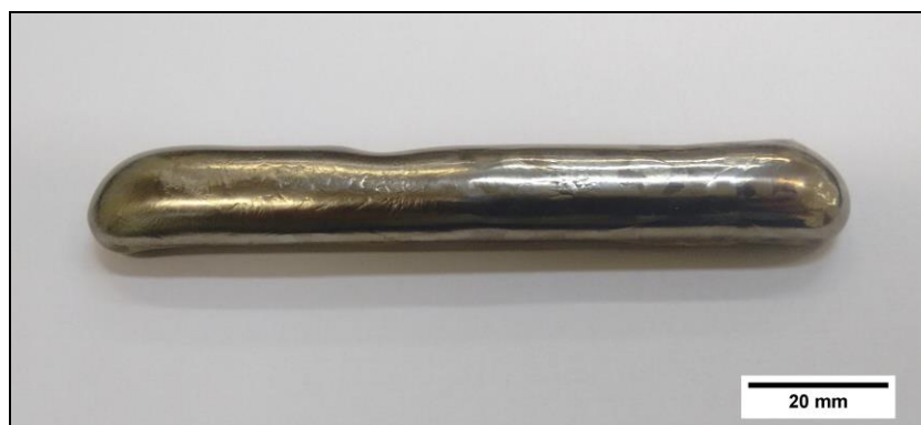
Figura 27. Lingote da liga Zir-Brasil-2 após a fusão.
