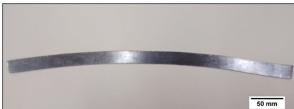
Figura 28. Chapa da liga Zir-Brasil-2 após processamento termomecânico.
