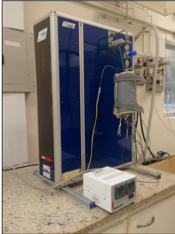
Figura 25. Equipamento utilizado no ensaio de cinética de absorção de hidrogênio.
