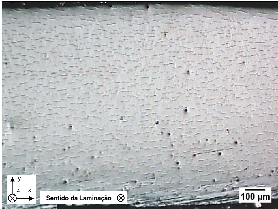
Figura 40. Micrografia da liga Zir-Brasil-2 (aumento 50x nominal).
