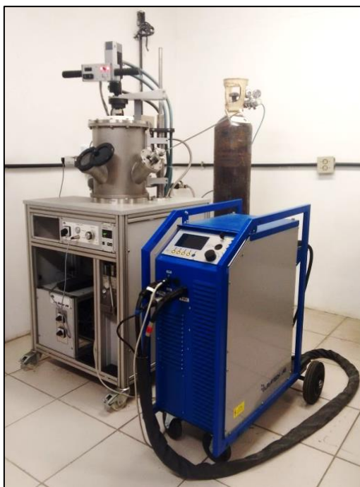
Figura 20. Forno elétrico a arco Bühler AM-VARIO 400.
