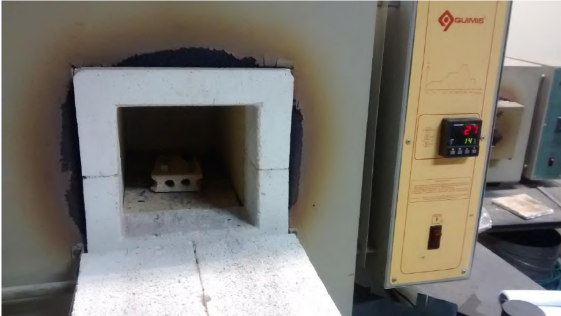
Figura 10: Disposição de amostras dentro do forno para tratamento térmico de alívio de tensões.
