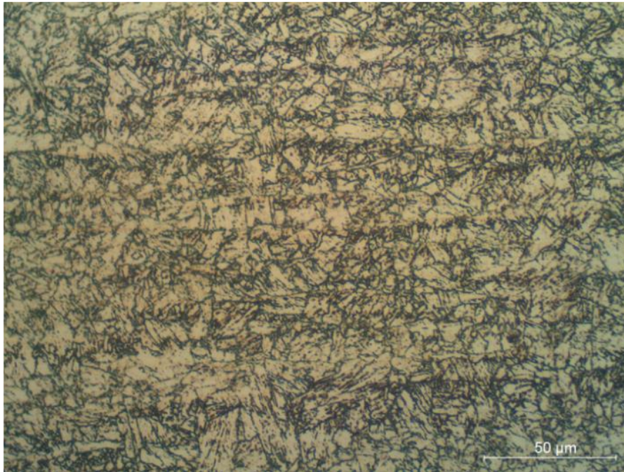
Figura 4: Microscopia ótica de chapa de aço 9Ni duplamente normalizado e temperado. Nital [2].
