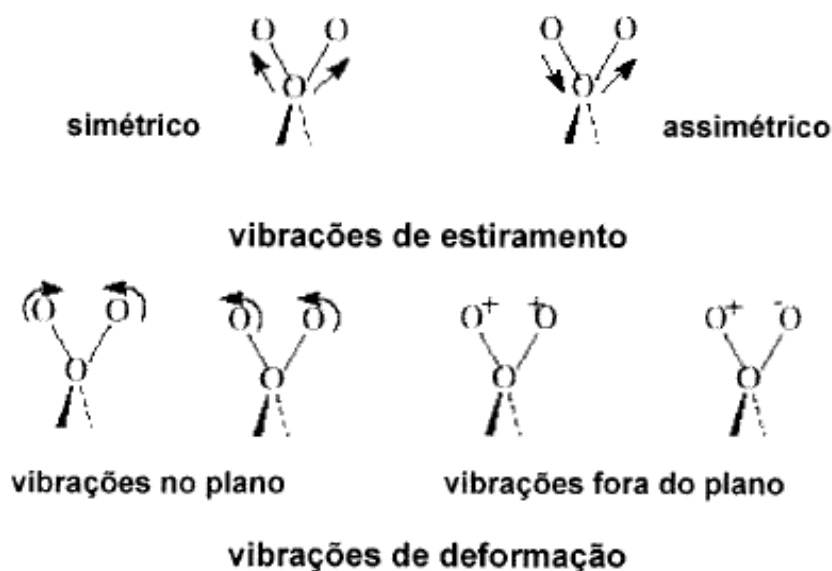
Figura 2.33: Principais tipos de vibrações moleculares. Os sinais + e - indicam vibrações perpendiculares ao plano do papel (Fialho, 2007)
