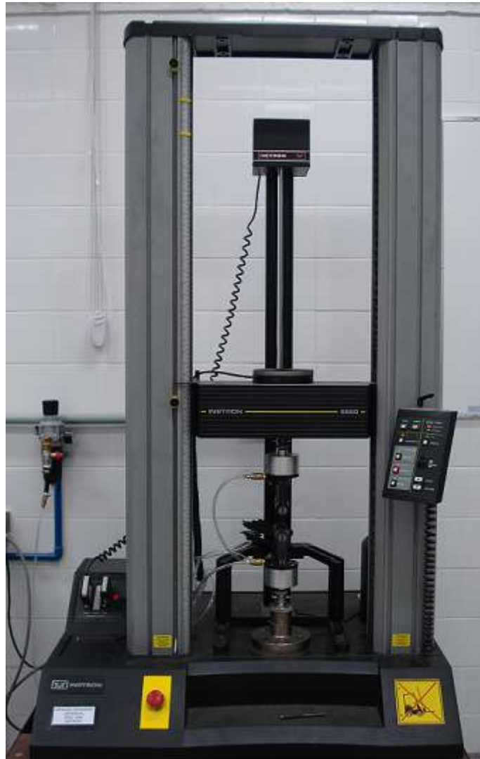
Figura 3.5: Equipamento para análise de resistência à tração, Instron- 5569
