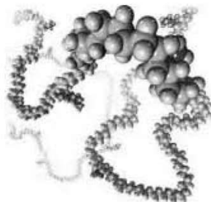
Figura 2.2: Representação esquemática da estrutura de PEBD (Coutinho, 2003).
