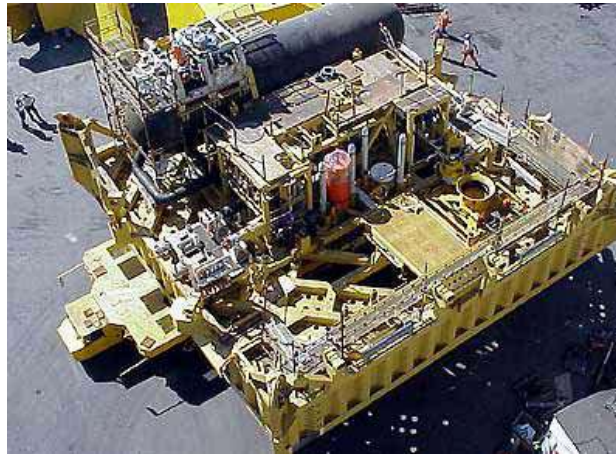
Figura II.18 – Separador submarino instalado no campo de Troll Pilot, no Mar do Norte(Pereira, 2004).
