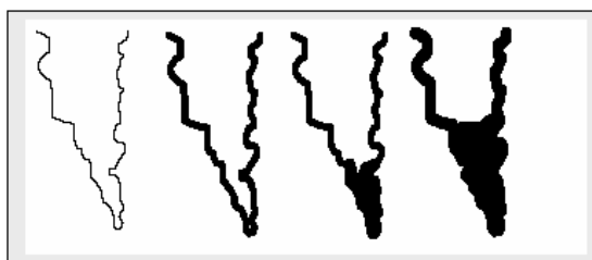
Figura II.28 – Representação esquemática da condensação por capilaridade. (Dalminger, 2004).
