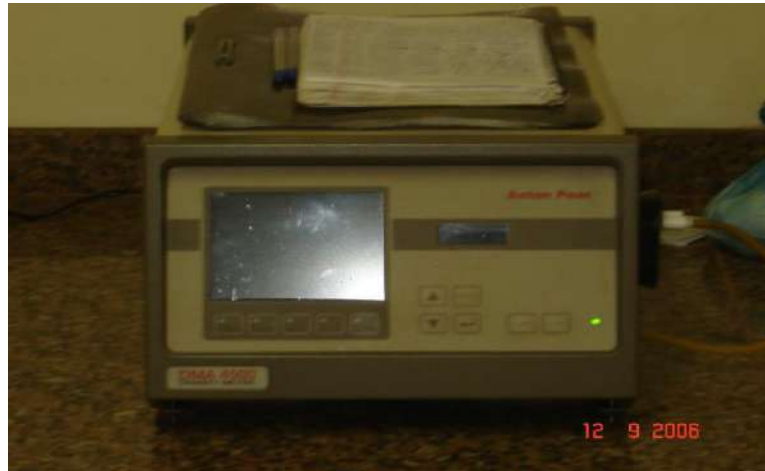
Figura IV. 9. Densímetro ANTON PAAR modelo DMA 4500, usado para medir os teores de extratos primário e aparente.
