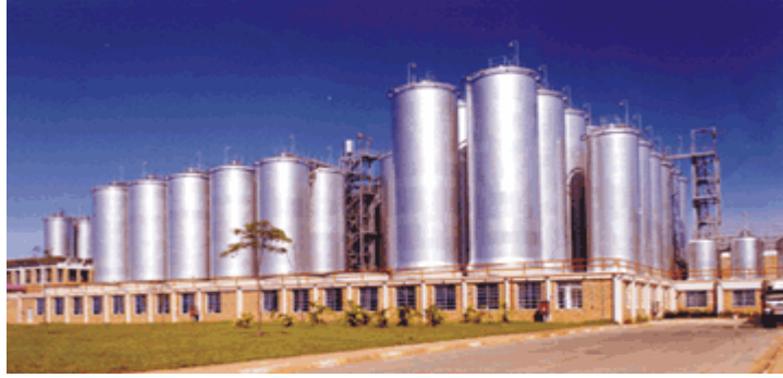
Figura III. 5. Tanques de fermentação do tipo outdoor .
