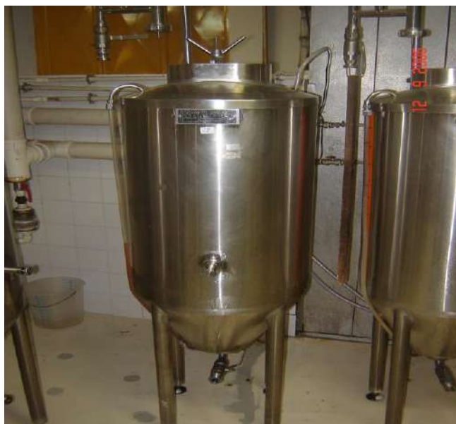
Figura IV. 6. Tanque de fermentação e maturação (Mec Bier)
