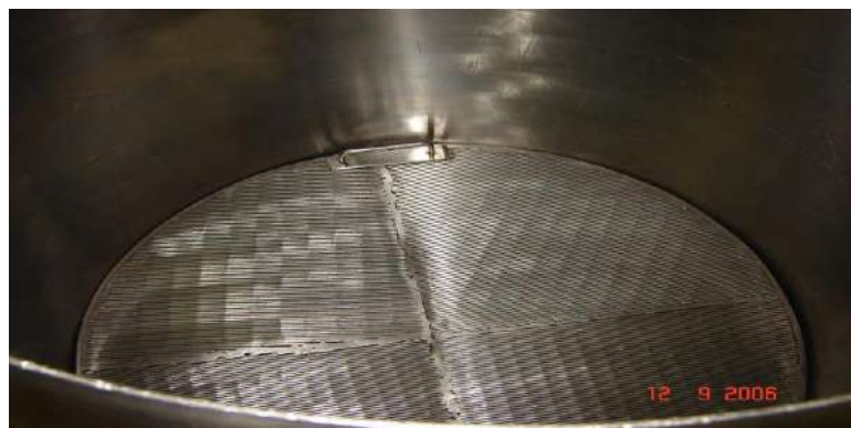
Figura IV. 5. Tanque de recirculação do mosto (Mec Bier)
