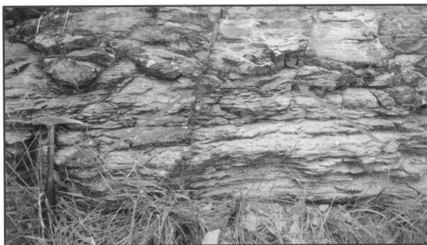
Figura 52 Planos de fraturas em arenito com a indicação da direção e do sentido de mergulho: N83°E/85°SE - 173°/85° (seta verde) e N85°E/85°SE - 175°/85° (seta azul).
