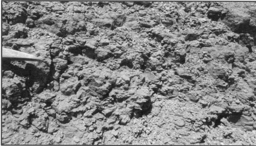
Figura 30 Litofácies L2 ( Fsm , Fm ) - Argilito laminado com coloração avermelhada (indicando forte oxidação).
