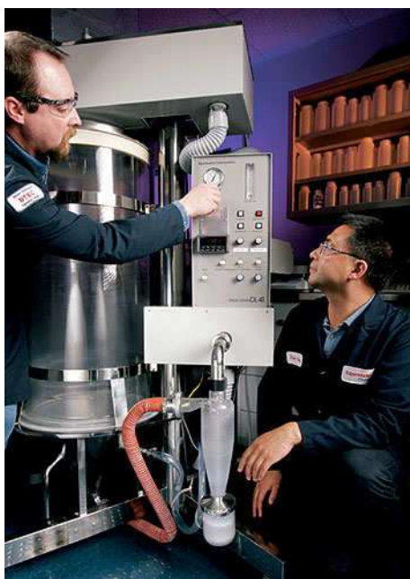
Figura 4.12. Produção de catalisador para processo GTO em escala de laboratório. O catalisador formado está na forma de microesferas.
