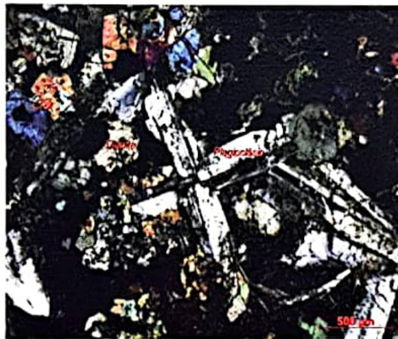
Figura 6 – Fotomicrografia de diabásio com textura intergranular. (Extraído de Fatah, 2011).
