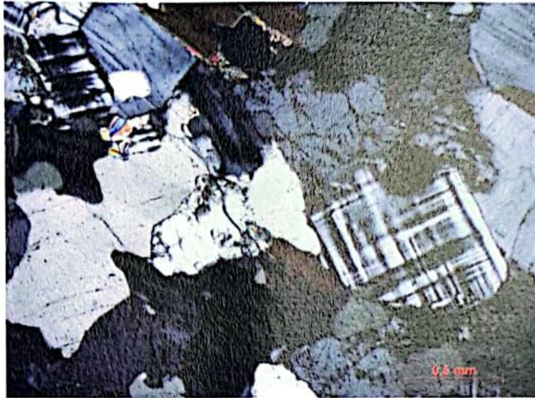
Figura 23 – Aspecto microscópico geral do leucogranito.
