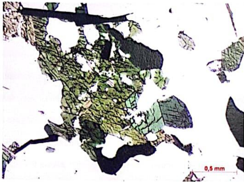
Figura 20 – Aglomerado de hornblenda em amostra do ortogneisse BSO.
