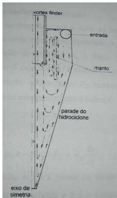
Figura 2.1-III - Esquema do fluxo radial e axial no interior do hidrociclone (Capela, 1994)
