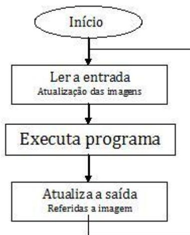
**Figura 13** – Ciclo de varredura do PLC
