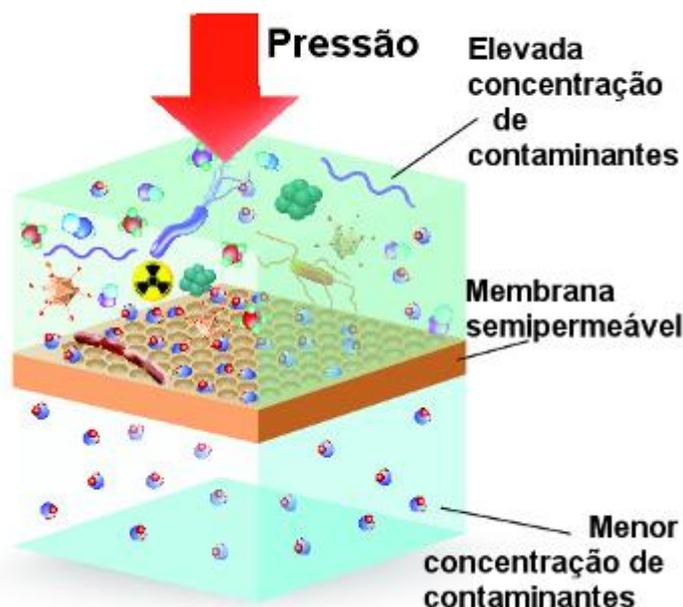
**Figura 8** - Ilustração de osmose reversa
