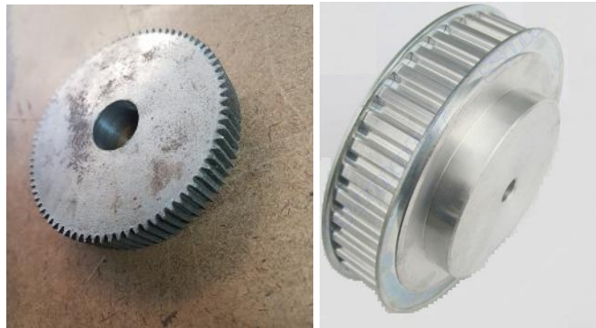
Figura 5.2: A esquerda engrenagem pinhão; a direita polia de sincronia.
