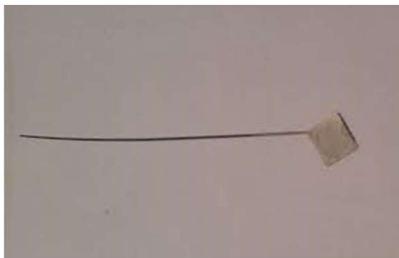
Figura 13 - Amostra de aço IF preparada para ser usada nos ensaios de permeação (A superfície da plaqueta mostrada é a niquelada)
