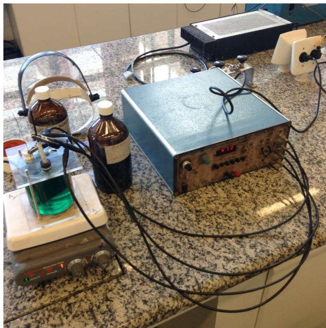
Figura 12 - Eletrodeposição de Ni sendo feita na amostra de aço IF
