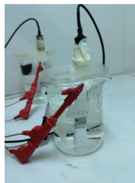
Figura 25: Foto panorâmica dos corpos de flexão hidrogenando.
