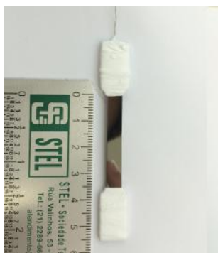
Figura 24: Corpo de tração com a delimitação na sua seção útil.
