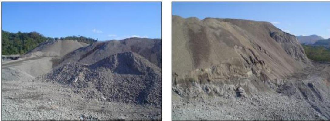
Figura 8: Depósito de escória de aciaria LD armazenada em pilhas (PEDROZA, 2010).
