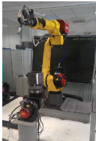
Figura 28: Robô utilizado nos processos GMAW e FCAW.
