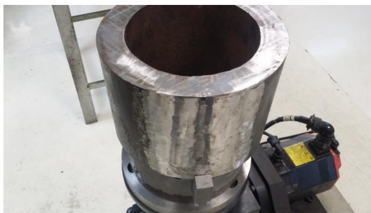
Figura 27: Tubo do aço 9%Ni A333 grau 8 com superfície esmerilhada.
