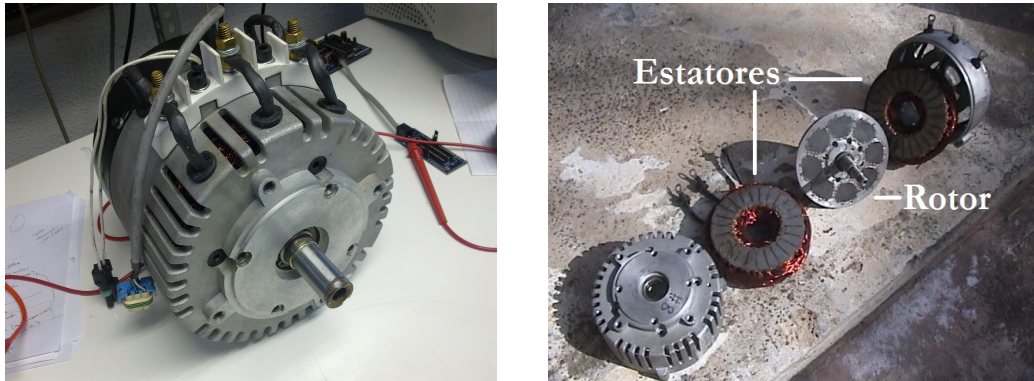
Figura 10: ME0913. A foto da direita foi retirada do forum em DIY Electric Car onde era discutida a construção de uma motocicleta com este motor.
