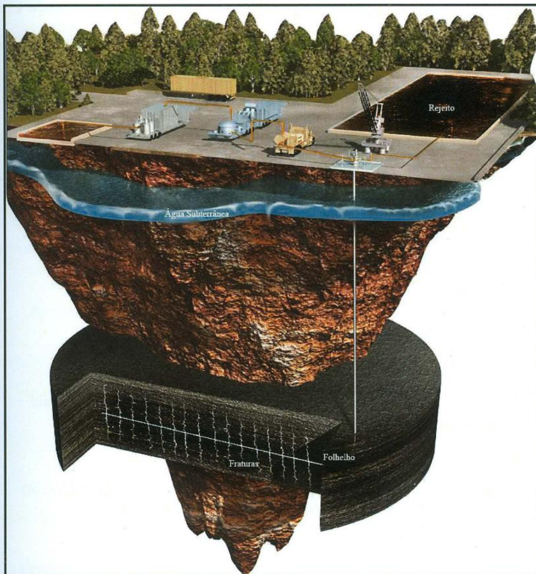
Figura 3: Modelo esquemático da extração do gás de folhelho. Fonte: Modificado da Scientific American, 2011.
