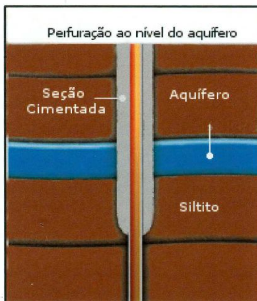
Figura 15: Modelo esquemático do envelopamento do aquífero.
