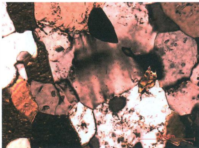
Figura 8.3: Fotomicrografia de cristal de microclina, exibindo geminação do tipo Tartan. Nicóis cruzados, amostra DB-41.
