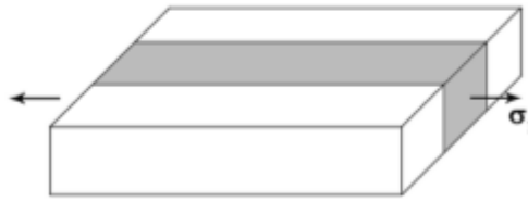
Figura 2-6: Representação de uma unidade volumétrica de um compósito reforçado por fibras (destacadas em cinza) sob efeito de um carregamento longitudinal
