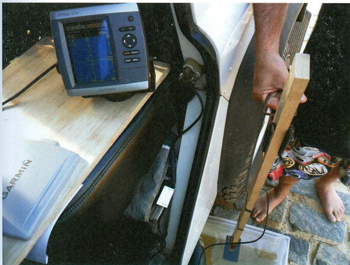
Figura 06. Teste do eco-batímetro ligado em bateria de carro.
