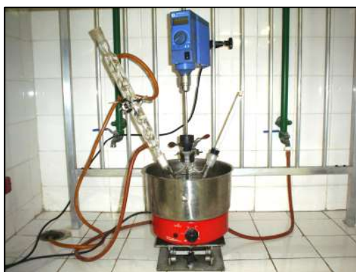
Figura 11. Foto da aparelhagem utilizada na síntese da Resina Fenólica à base de LCC.
