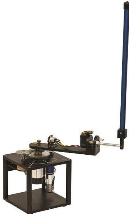
Figura 3.1: Pêndulo Invertido Rotacional.
