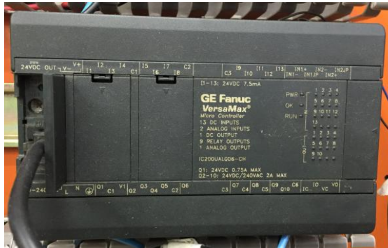
Figura 2.5: Foto do Controlador Lógico Programável modelo GE Fanuc VersaMax IC200UAL006
