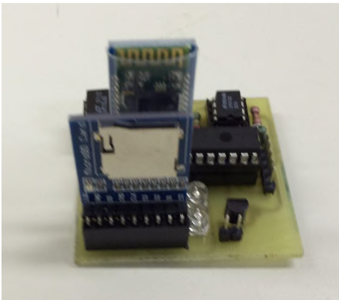
Figura 4.10: Placa vista de outro ângulo, com destaque para interface de cartão SD e módulo Bluetooth
