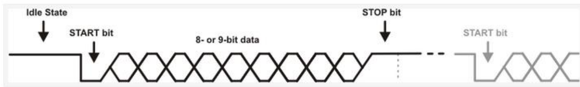
Figura 4.1: Ilustração da transmissão de um byte pelo protocolo RS-232 [21]
