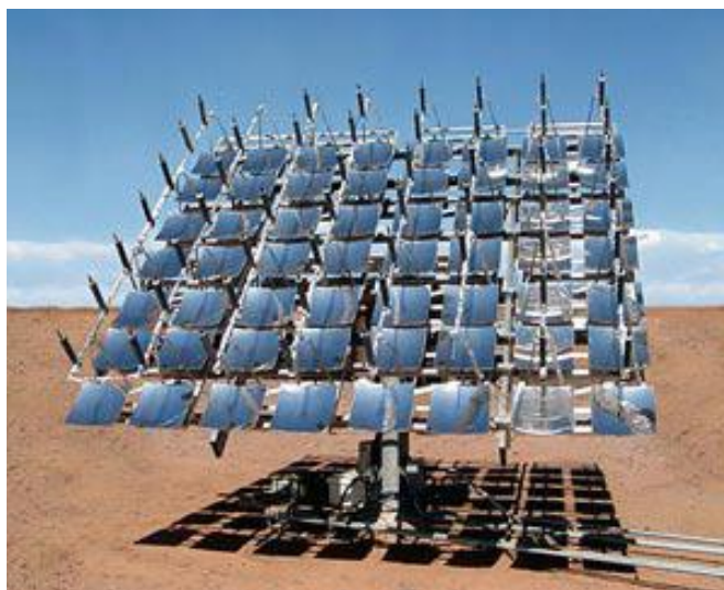
Figura 2.8: Sistema concentrador fotovoltaico do tipo micro prato. Fonte: www.cleanenergyauthority.com .
