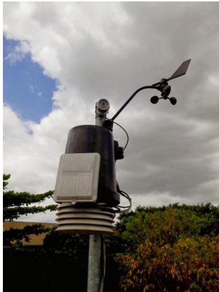
Figura 4.9: Estação meteorológica. Fonte: Davis Instruments.
