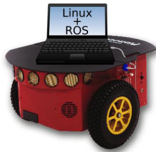
Figura 4.5: Robô Pioneer 3DX controlado por um computador portátil.
