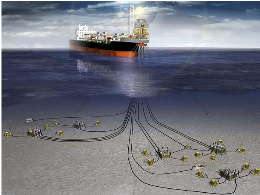
Figura 3 - Esquemático de extração de petróleo com FPSO (topside, turret), raisers, manifold, sleds, jumpers entre outros (BAI et al., 2010)
