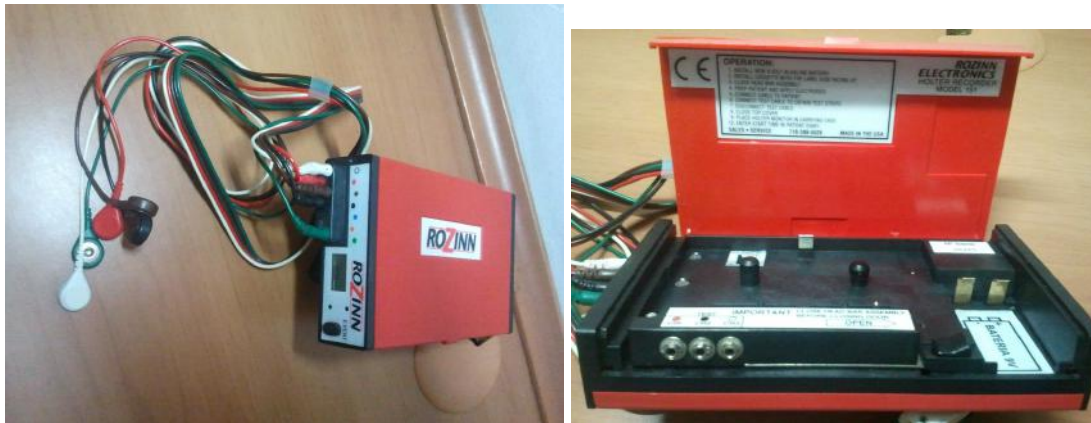
Figura 3.2: Eletrocardiógrafo Holter em fita cassete utilizado pelos pacientes. Reproduzido com permissão de Alex Chaves Alberto.
