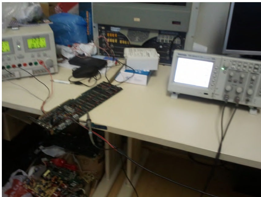
Figura 3.6: Experimento para obtenção da curva de resposta em frequência da placa de aquisição.
