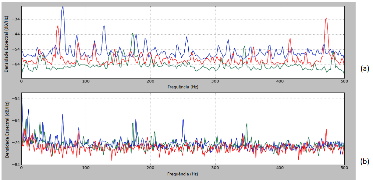
Figura 9.2: Densidades espectrais - (a) sinal sem filtro (b) sinal com filtro.
