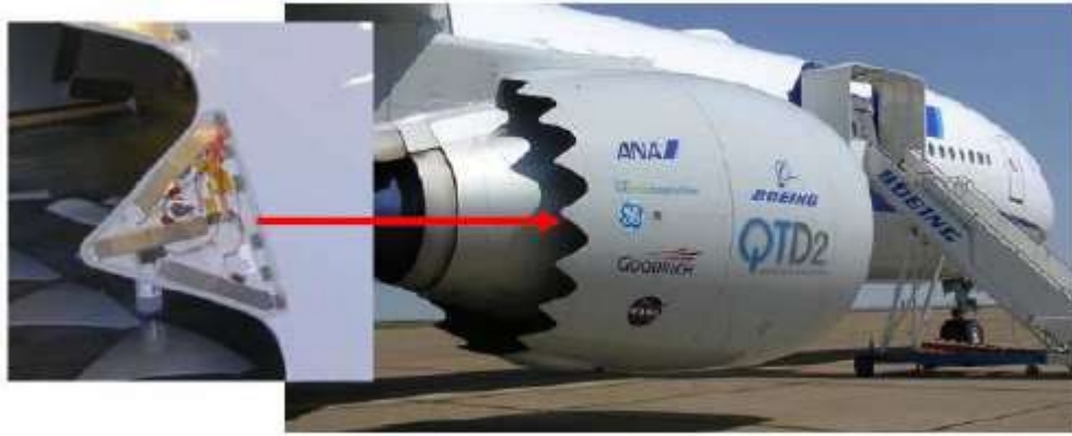
Figura 11 - Chevrons em turbinas de aeronaves (Garcia, 2015)
