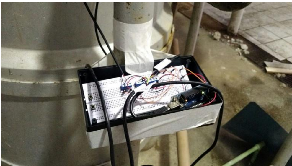
Figura 26 - Arduino conectado aos dispositivos na planta
