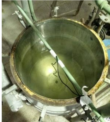
Figura 31 - Foto do arranjo dos termômetros no tanque 1
