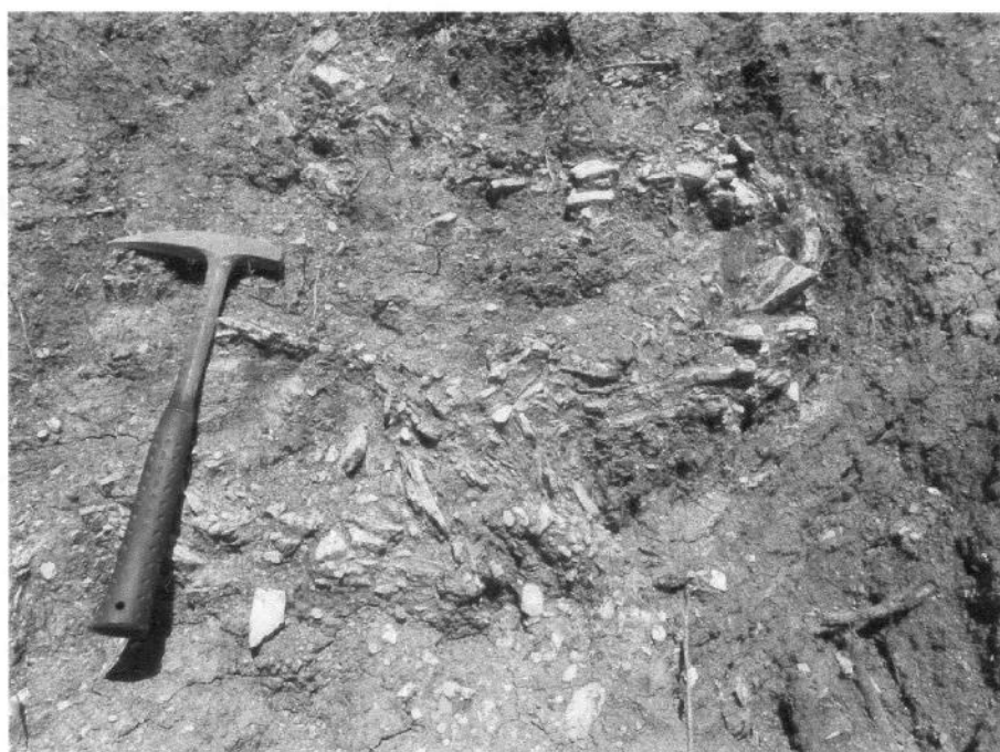
Figura 27 Calcarenito esverdeado dobrado da parte deformada do afloramento do Ponto 5. Localizado no município de Brejo Santo – CE, Transnordestina, 1 km a SW do estádio de futebol.
