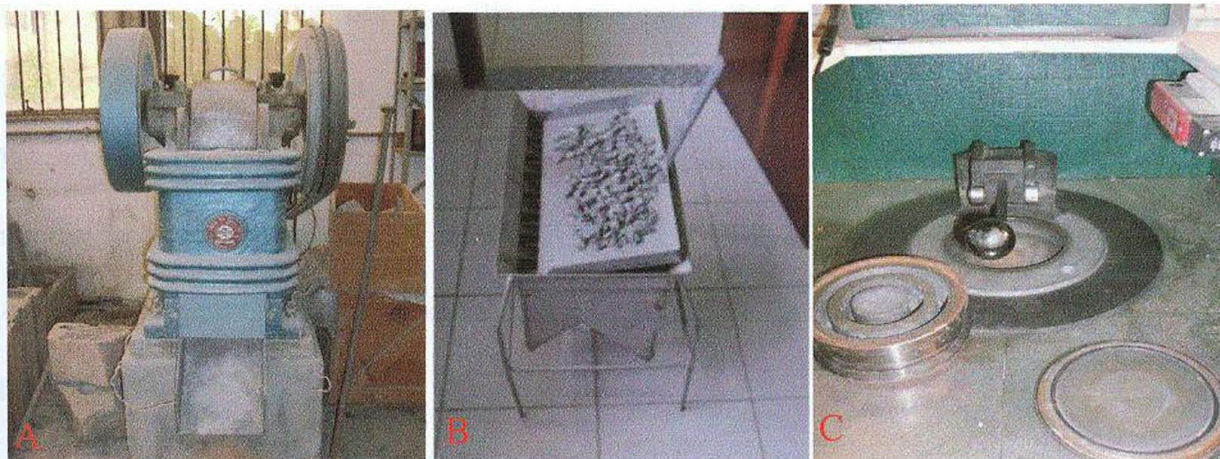
Figura 1: Equipamentos utilizados na preparação das amostras para análise química: A) Britador de Mandíbulas; B) Quarteador; C) Moinho de panela.
