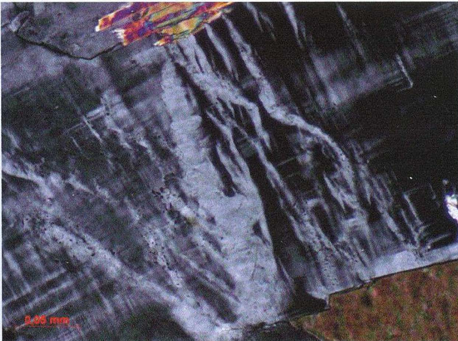
Figura 14: Detalhe de K-feldspato com pertita em lâmina do leucognaisse.
