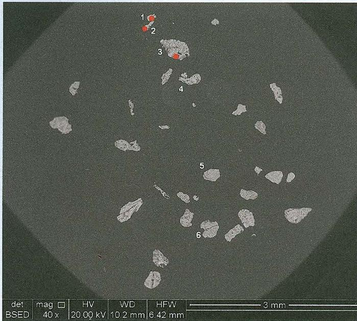
**Figura 33:** Imagem geral da seção polida FA-06, com os grãos de óxido de Ti (rutilo ou anatásio ou brookita) estudados e respectivas localizações das análises químicas efetuadas.
