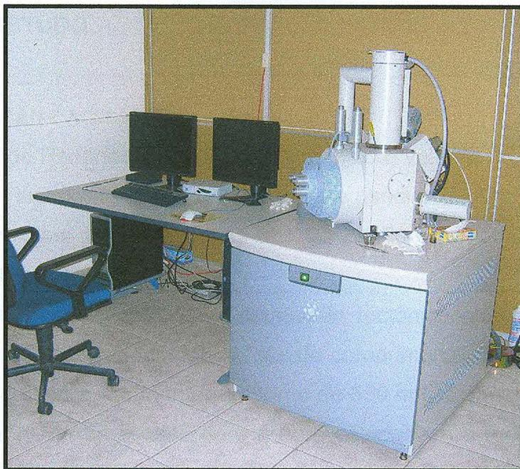
**Figura 1:** *Microscópio eletrônico de varredura com microanálise pontual por dispersão de energia (MEV-EDS) do Centro de Tecnologia Mineral (CETEM/MCT) utilizado neste trabalho.*
