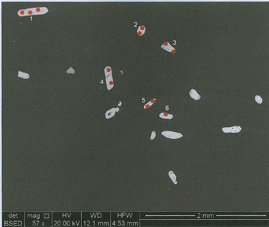
**Figura 44:** Imagem geral com 6 (seis) grãos de zircão da seção polida GA-04 e respectivas localizações das análises químicas efetuadas.
