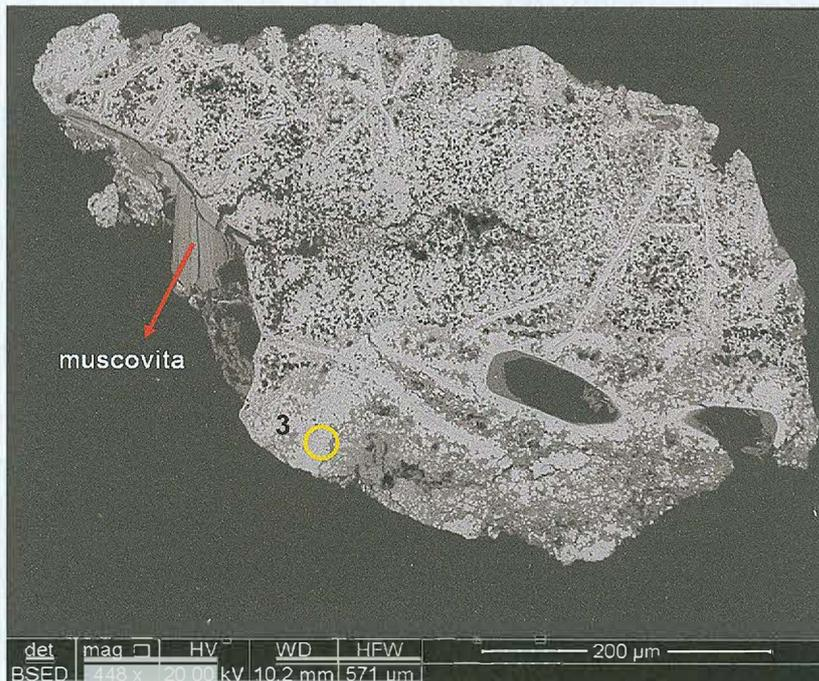
**Figura 34:** Imagem do grão 3 de óxido de Ti (rutilo ou anatásio ou brookita), fortemente alterado, da seção polida FA-06, com paragénesese com um cristal de muscovita, e respectiva localização da análise química efetuada.
