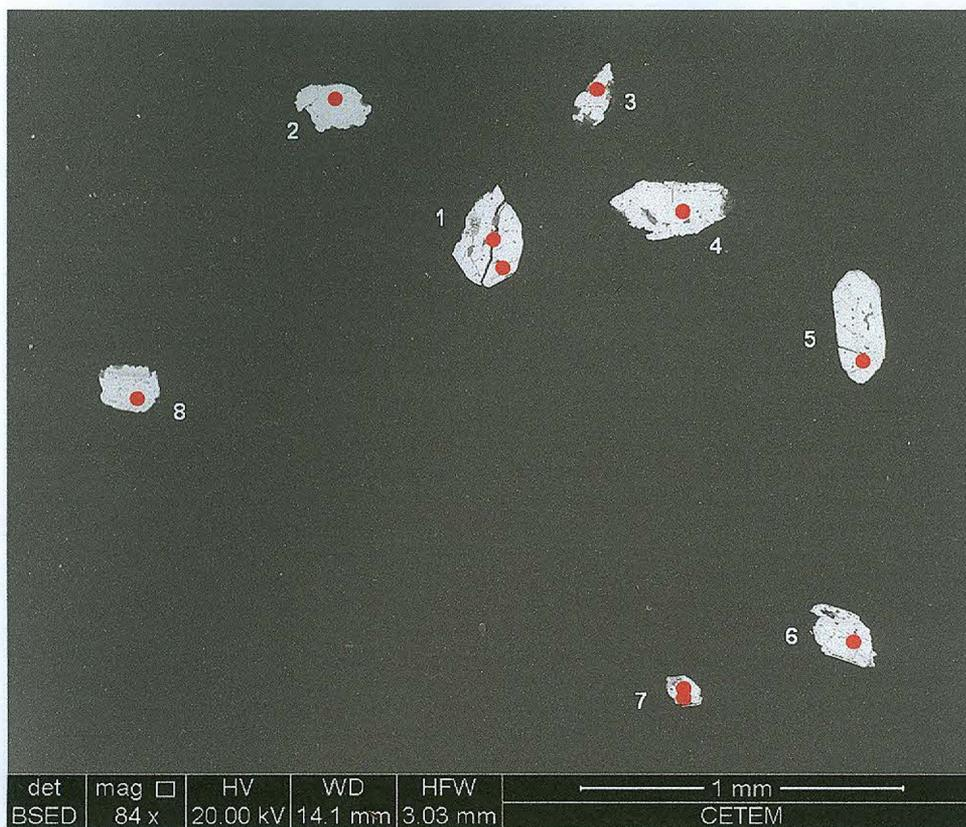
**Figura 35:** Imagem geral da seção polida FA-07, com os grãos de zircão estudados e respectivas localizações das análises químicas efetuadas.
