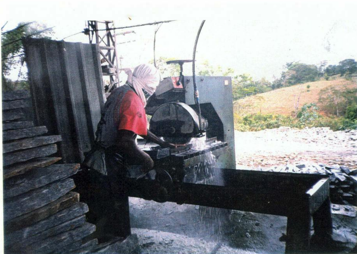
Fotografia 12: Observa-se o funcionário cortando a rocha com a serra, sendo refrigerada com água.
