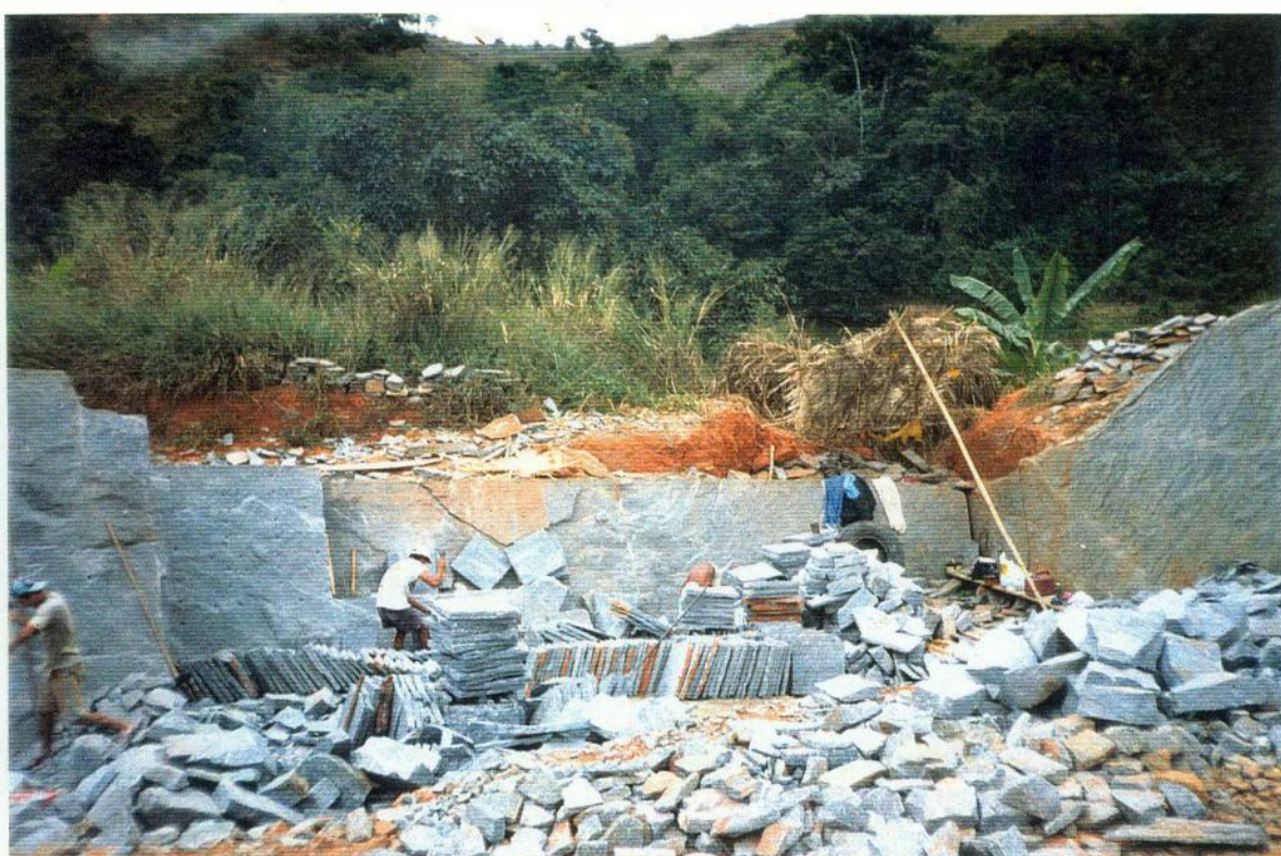
Fotografia 05: Visão mais geral mostrando o aspecto de uma frente de lavra, onde as placas de 50 cm x 50 cm encontram-se agrupadas.
