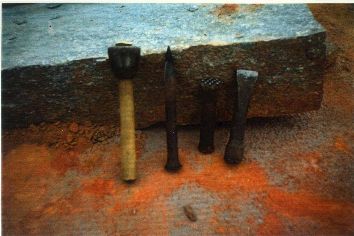
Fotografia 15: Instrumentos utilizados para pecuar a rocha. O da extrema direita chama-se escopa, depois vem o instrumento para pecuar, seguido pelo ponteiro e a maceta na extrema esquerda.
