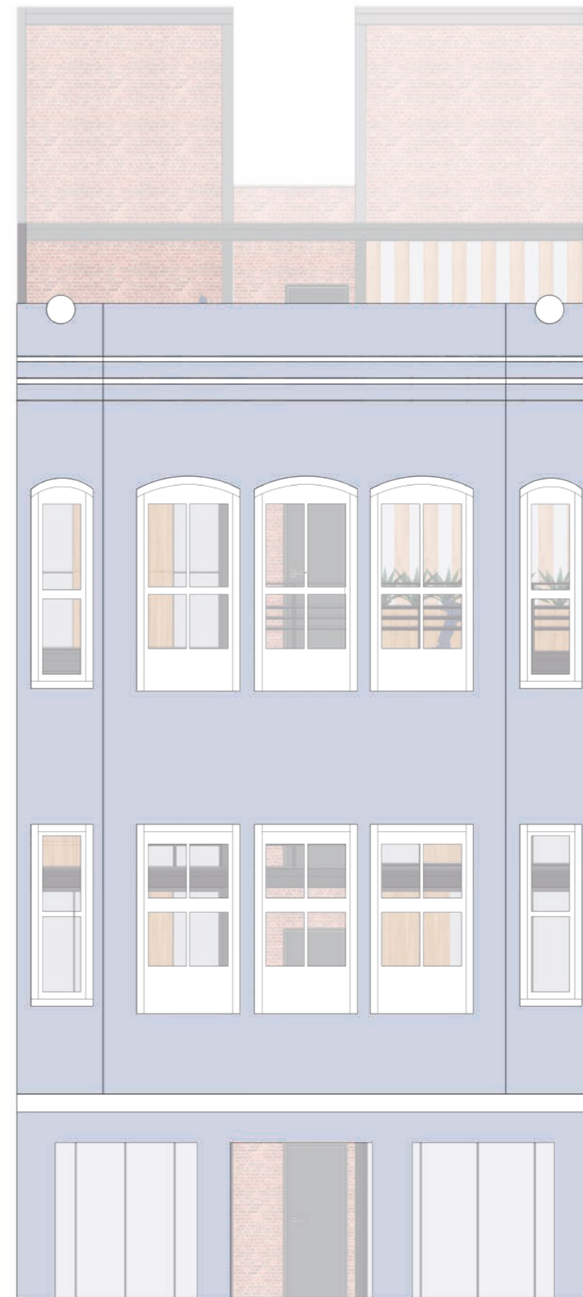
Fachada por fora da ruína, onde é possível ver as aberturas da ruína e do edifício novo em conexão. Fonte: acervo da autora
