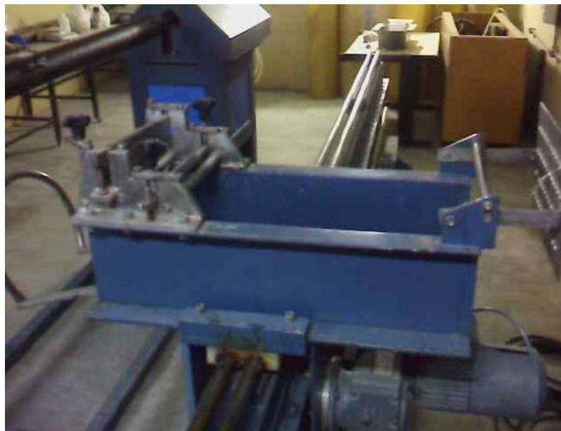
Figura 4.11. Plataforma móvel onde as fibras são previamente banhadas na resina
