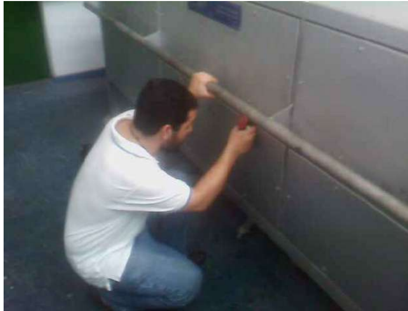
Figura 4.16. Forma de medição da temperatura no tubo. Pequena abertura da estufa em vários instantes para evitar variação brusca da temperatura interna.
