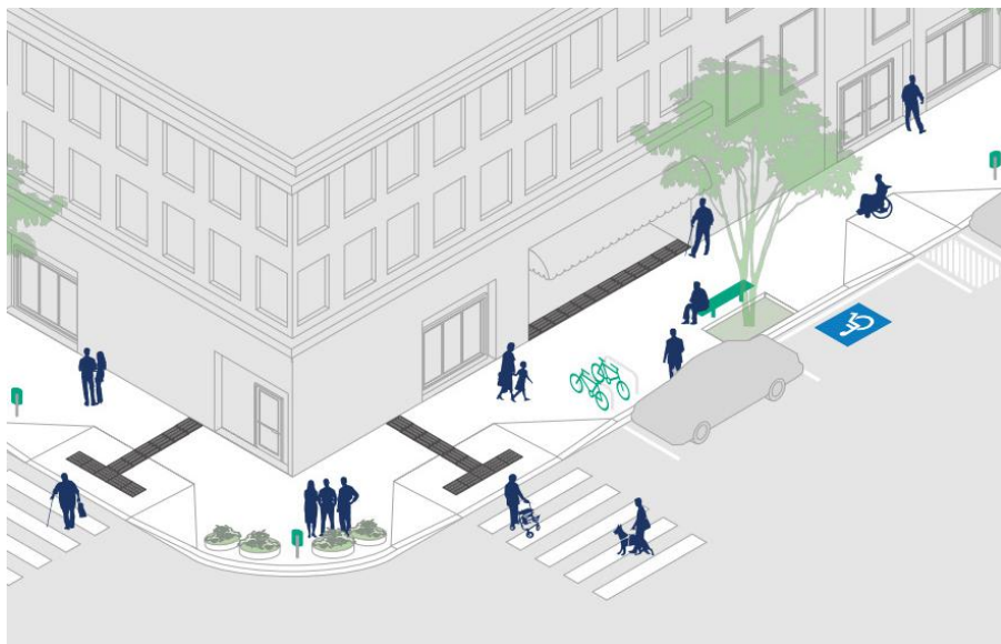
Imagem 58 - Esquema de uma calçada com base nas normas ABNT NBR 9050/2015 e ABNT NBR 16537/2016 / Fonte: Calçada Certa – Manual do Projeto e execução
