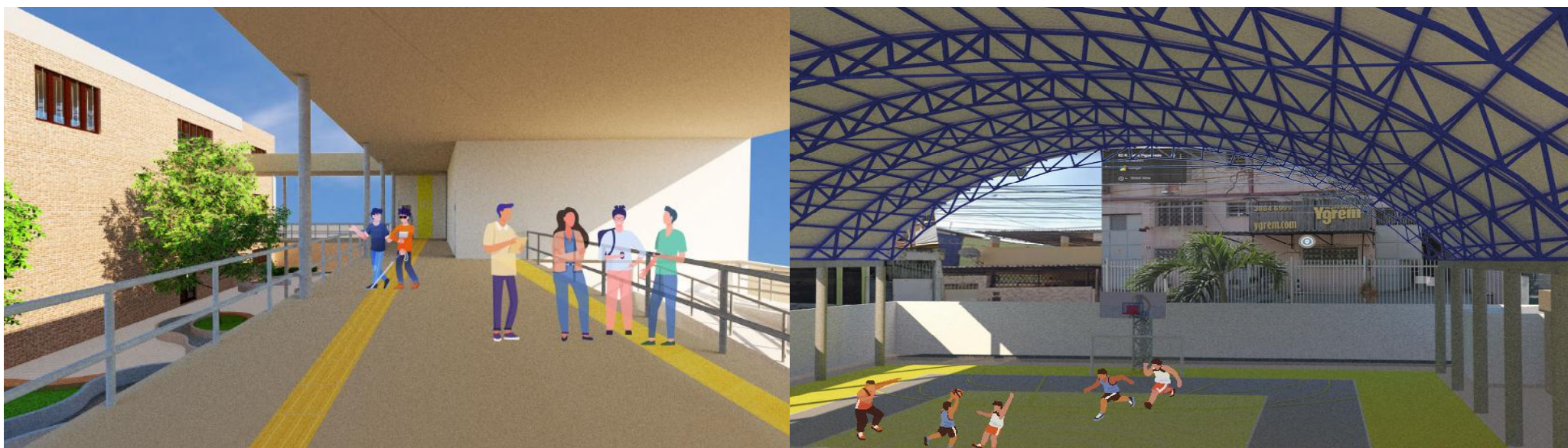
05. Vista do 2º pavimento. Corredores com sinalização tátil para deficientes visuais.
