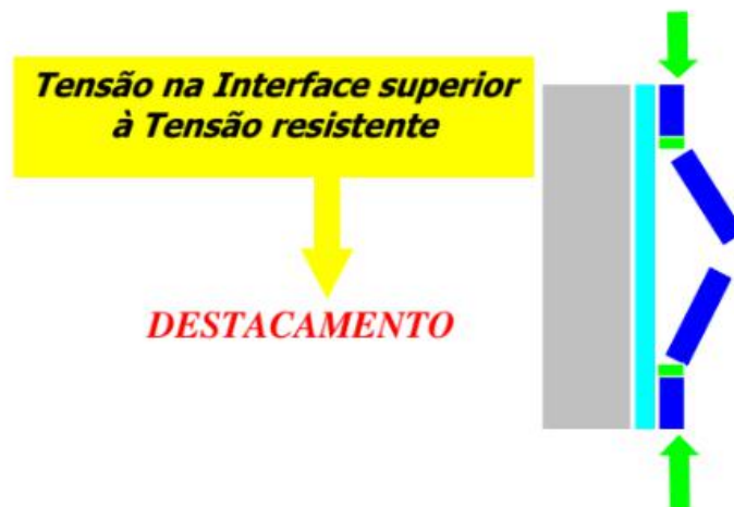
Figura 15 - Destacamento com expansão por umidade (Fonte: Pedro et. al., 2009)
