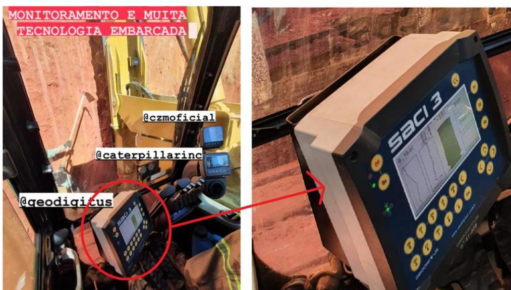
Figura 2.4 - Computador de bordo com software Saci3, cortesia Solo Suporte Fundações.
