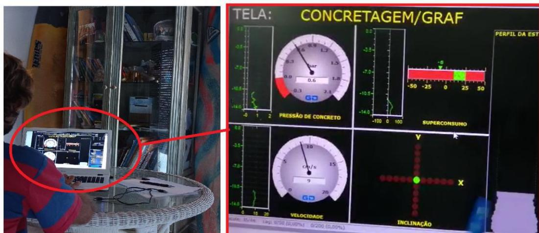
Figura 2.3 - Sistema de monitoramento remoto (cortesia Solo Suporte Fundações)
