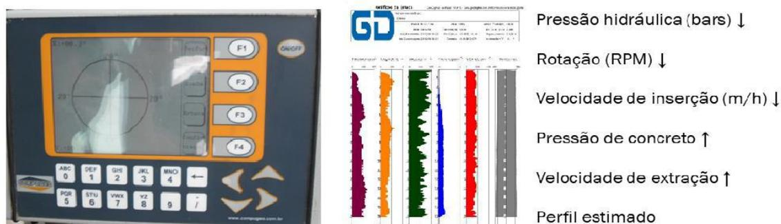
Figura 2.2 - Sistema de monitoramento da perfuratriz e exemplo de boletim de monitoramento (cortesia Solo Suporte Fundações)
