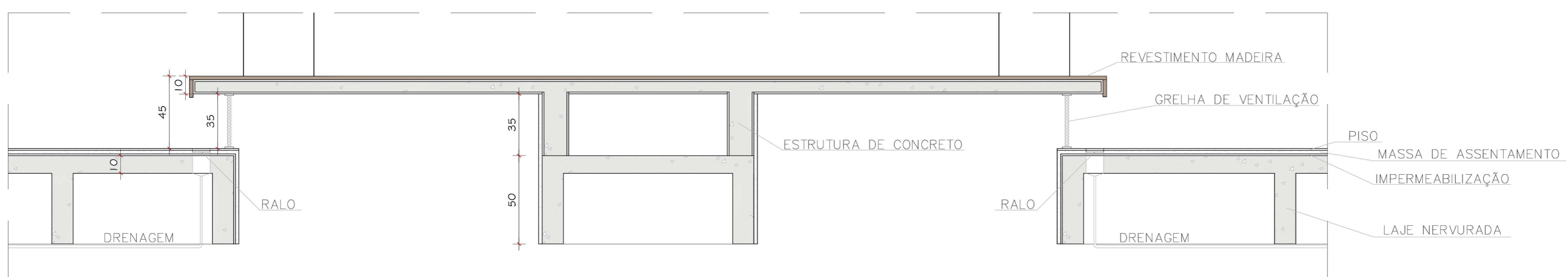
DETALHE 05 – VENTILAÇÃO SUBSOLO ATRAVÉS DOS DECKS Escala 1:20
