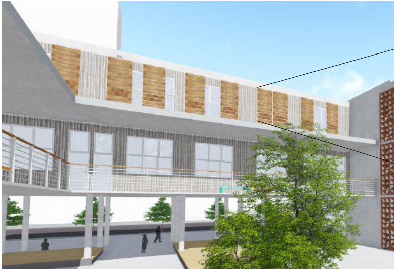
Figura 97: Imagem da fachada noroeste do prédio de Capacitação, onde é usado brise horizontal. Fonte: Autoral.
